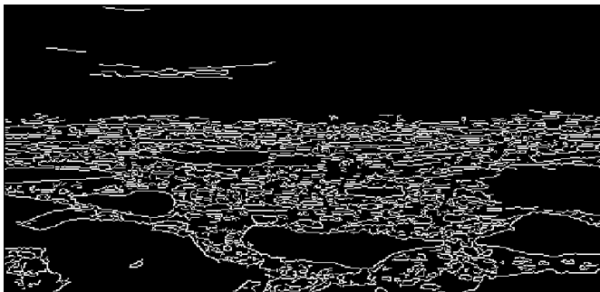
Abb.14: Visualisierung des canny edge -Algorithmus
